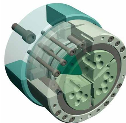
Sonderspannfutter zum Außenspannen in der Anwendung Zerspanen, Fügen, Pressen, Prüfen, Schweißen etc.
